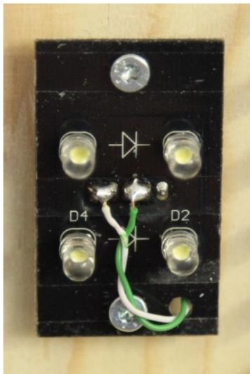
Die „Punkte“ zwischen den ersten beiden Ziffern und den letzten zwei Ziffern sollten, wie es das Diagramm rechts zeigt, gesteuert werden. Die Transistoren sind BC547- und das Ganze wird auf einer kleinen Platine am leichtesten aufgebaut. Hier kann auch Schraubklemmer für die Verteilung von 12V angelegt werden.
